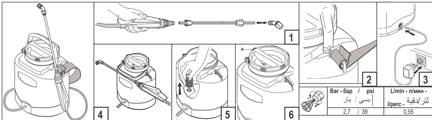
**1 - Montage – Mise en service (fig.1 à 3)**
